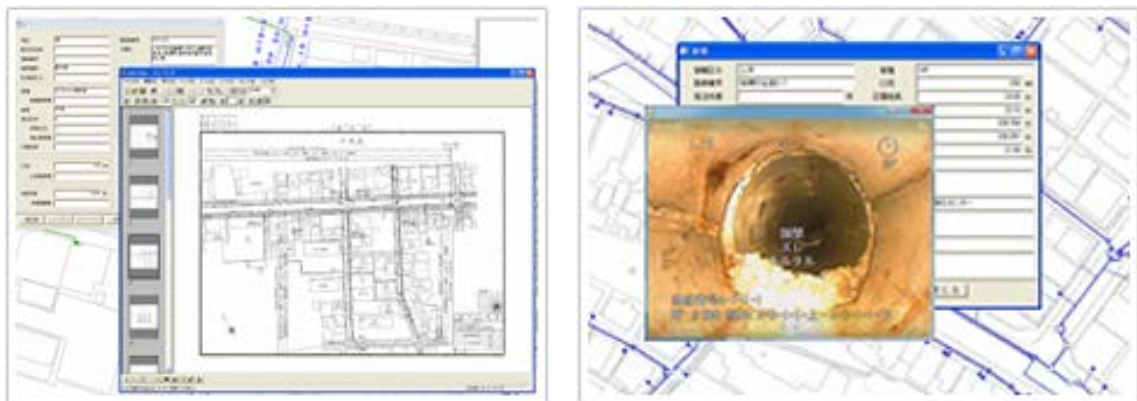
図 4.2.1 水道施設管理システム(左)および下水道施設管理システム(右)のイメージ
