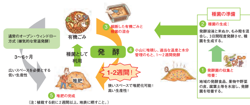
図8. 高倉式堆肥化手法の作業手順 (技術監修: ジェイバック株式会社 高倉弘二氏)
